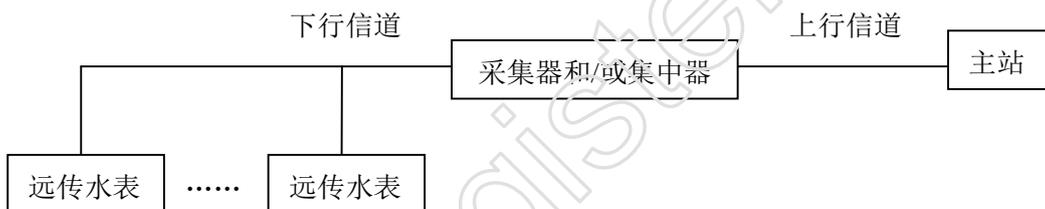
图1 远传水表自动抄表系统结构示意图
