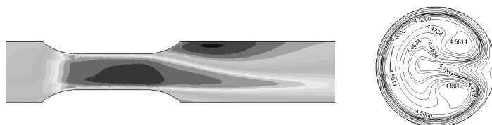
图 7 进口处有平面单弯管时的流速等值线分布图和截面流线图
