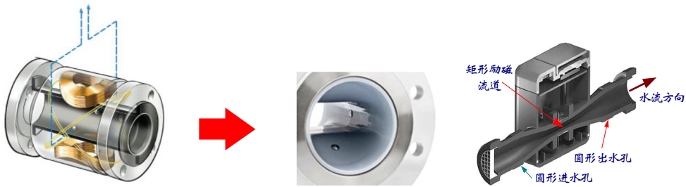
图 15 矩形测量截面可消除权重函数对测量结果带来的影响
